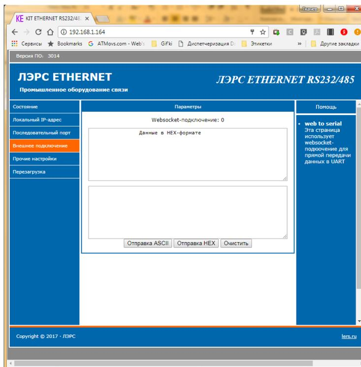
Обмен данными может производиться в текстовом или шестнадцатеричном виде.
