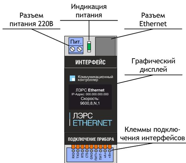
Рисунок 1. Внешний вид Ethernet
