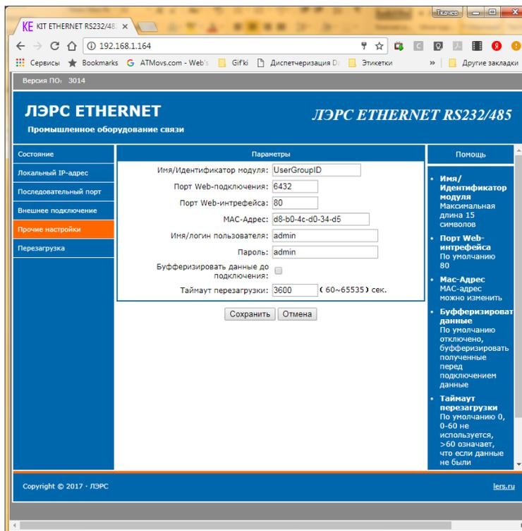
Поле «Имя/Идентификатор модуля» позволяет указать понятную человеку метку идентифицирующую контроллер или объект на котором он установлен. Данное поле может передаваться при подключении к серверу сбора данных в режиме типа идентификации «Модель и серийный номер».
