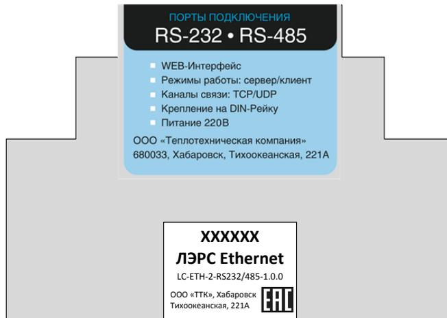
Рисунок 4. Место расположения маркировки
